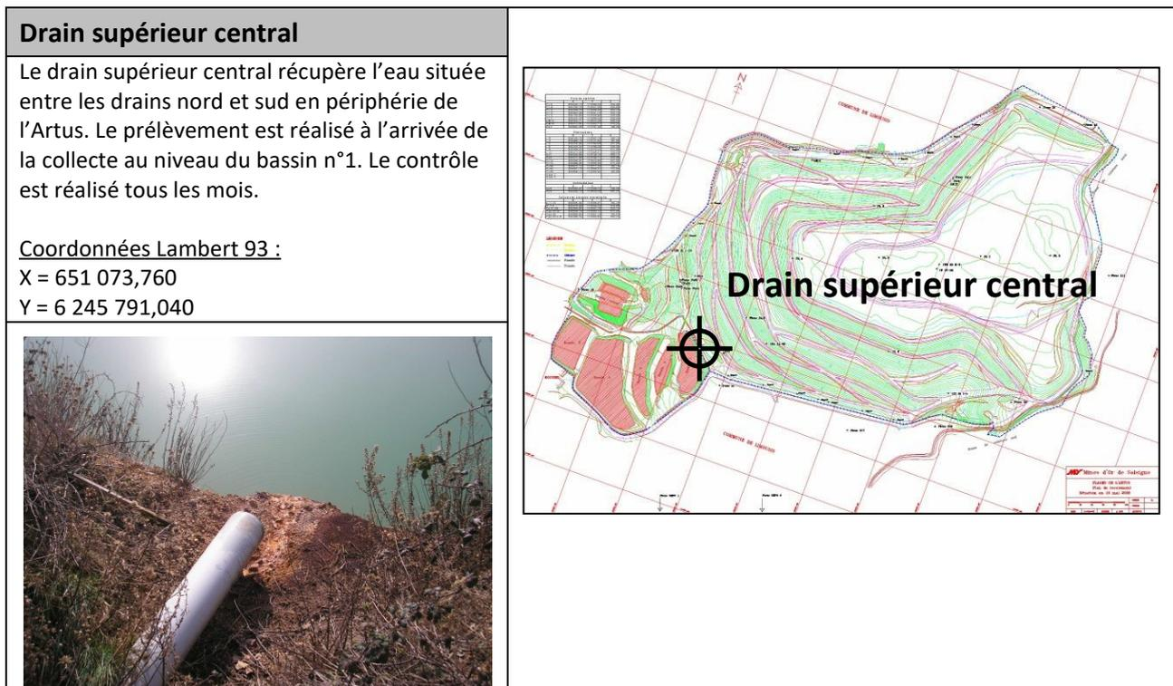
Figure 90 : Fiche prélèvement drain supérieur central
